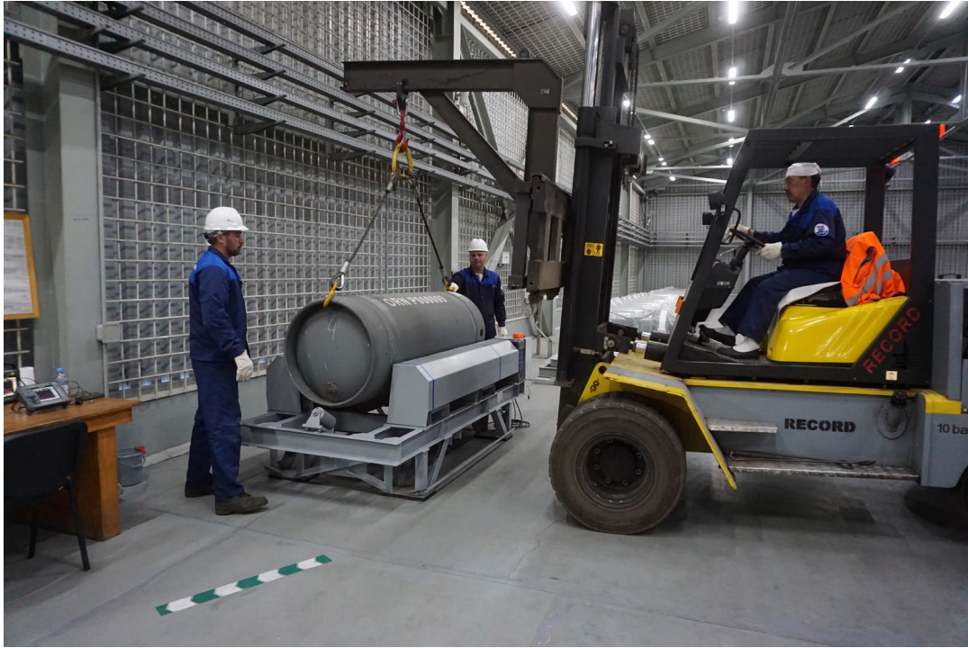
الشكل- باء-3- إعادة اعتماد اسطوانات 30B المملوءة باليورانيوم الضعيف الإثراء في مصرف الوكالة لليورانيوم الضعيف الإثراء.
