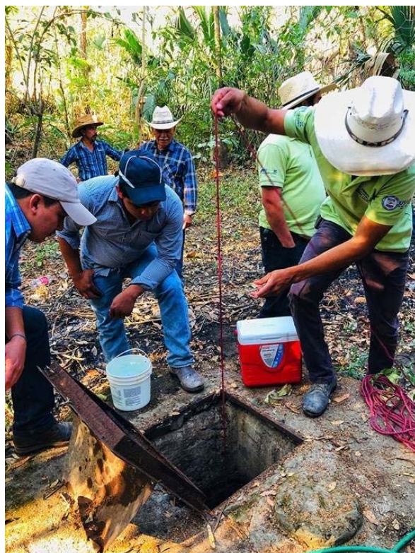
洪都拉斯伦皮拉省穆帕拉卡市的地下水位深部测量和地下水同位素采样。（图片来源：Ricardo Murrillo/哥斯达黎加）
