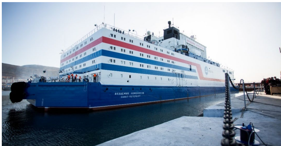
FIG. A-8. D'une capacité de 70 MWe, la centrale nucléaire Akademik Lomonosov équipée de deux réacteurs KLT-40S est exploitée à des fins commerciales depuis mai 2020 à Pevek (Fédération de Russie). (Photo : OKBM Afrikantov, filiale de Rosatom)
