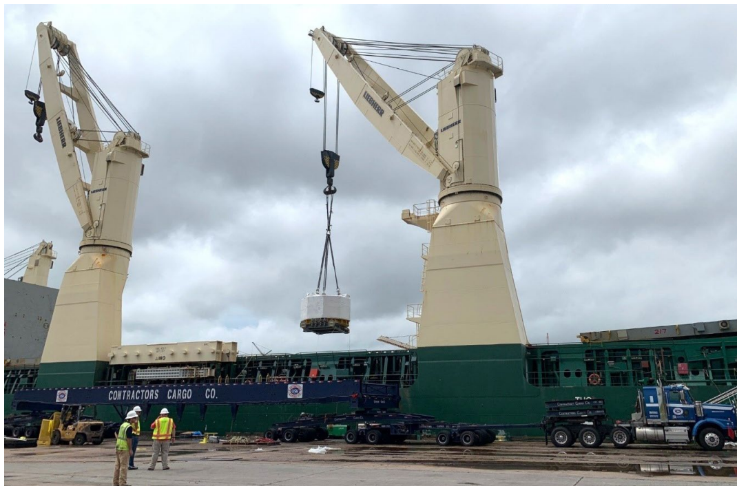
FIG. A-10. Chargement du solénoïde central de 110 tonnes dans la soute d'un cargo pour son transport des États-Unis vers le site ITER en France. D'une hauteur d'un immeuble de cinq étages, cet aimant central de 1 000 tonnes induira un courant électrique de 15 millions d'ampères dans le plasma du réacteur ITER afin d'initier chaque pulsation de plasma et d'assurer la stabilité verticale de ce dernier. Pour ce faire, le solénoïde central générera un champ magnétique d'une force de 13 teslas, soit un champ environ 280 000 plus puissant que le champ magnétique terrestre. (Photo : US ITER)
