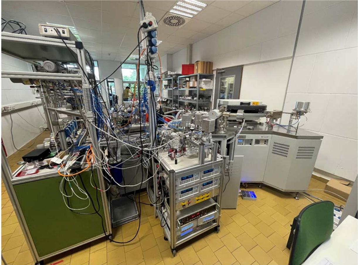
الشكل باء-2- النظام الجديد المتقدم من أجهزة قياس الطيف الكتلي بالهليوم-3 لتحليل تركيزات التريتيوم باستخدام طريقة نمو الهيليوم-3، المُركَّب في مختبر الهيدروولوجيا النظرية. (المصدر: الوكالة)
