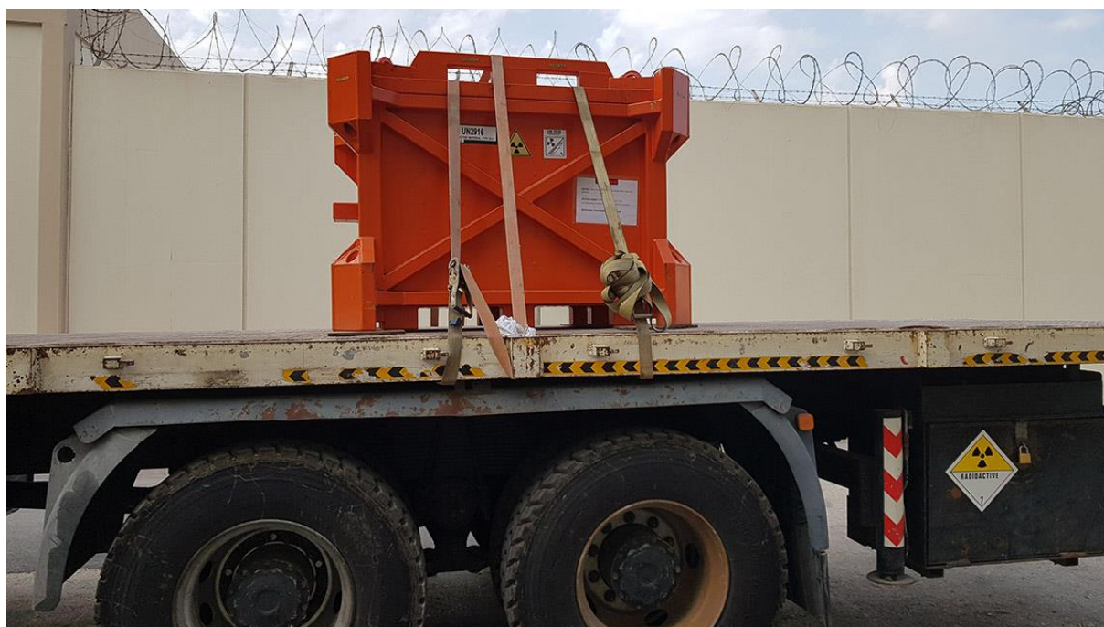
Изъятый из употребления закрытый радиоактивный источник, упакованный в лицензированный контейнер для международной перевозки. (Фото: подрядчик МАГАТЭ)
