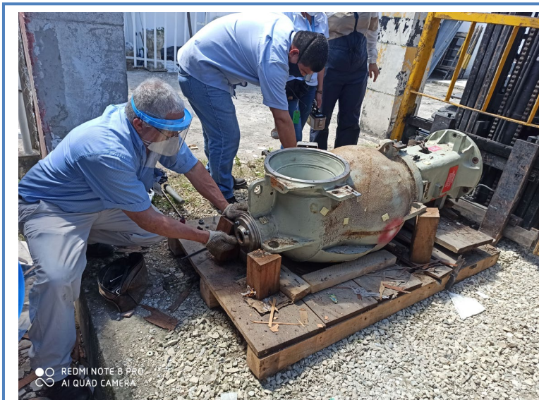
专家们在哥伦比亚拆除用于癌症治疗的远距治疗头， 以备安全可靠贮存
