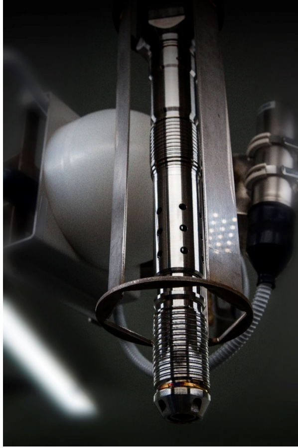
الشكل-باء-٢- مجمعة وقود موكس معدة للاستخدام في المفاعل السريع BN-800. (الصورة من: المجمع التعديني والكيميائي، الاتحاد الروسي)
