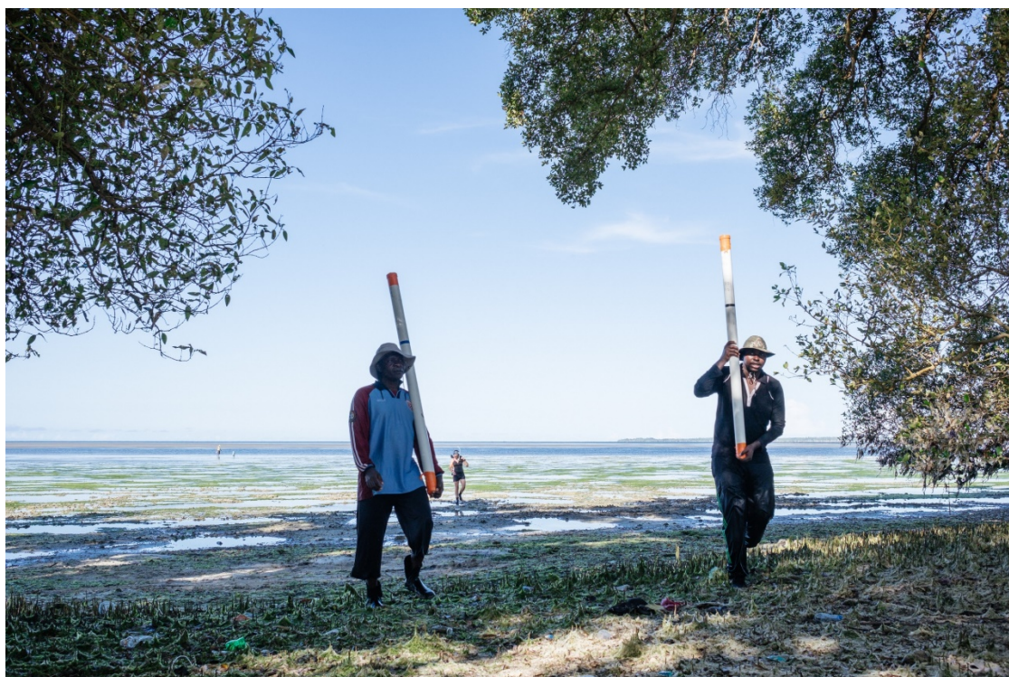
الشكل-حاء-٣- اثنتان من عينات الرواسب الجوفية الاسطوانية المأخوذة في زنجبار بجمهورية تنزانيا المتحدة بهدف تقييم مخزونات الكربون العضوي ومعدلات دفنه ككميـاس للقدرة على احتجاز الكربون. (الصورة من: غلوريا سالغادو، جامعة إيديث كوان، بيرث، أستراليا)
