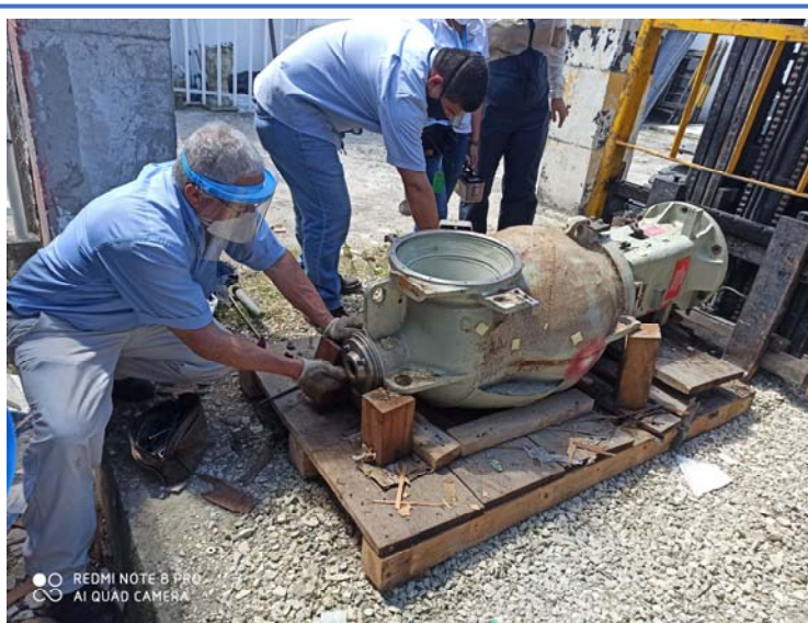
Специалисты демонтируют головку телетерапевтической установки, использовавшейся для лечения рака в Колумбии, в процессе ее подготовки к безопасному и надежному хранению
