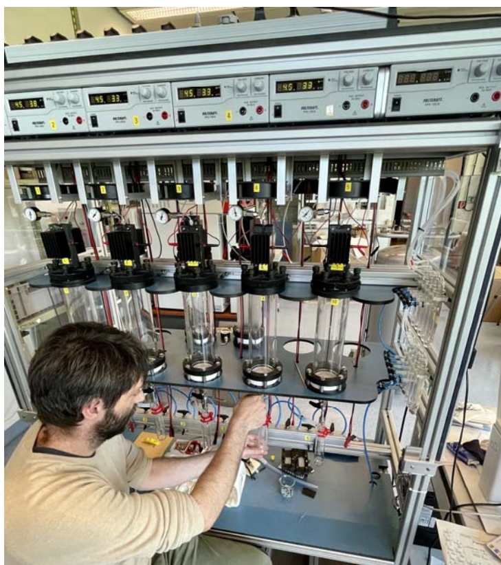
图 B.1. 基于渗透性电解膜技术的氮富集新方法。（来源：原子能机构）
