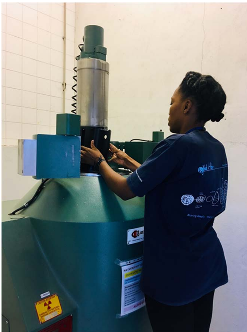
图 B.1. 雄蚊被装入 \gamma 射线 220 辐照装置室内进行绝育处理。
