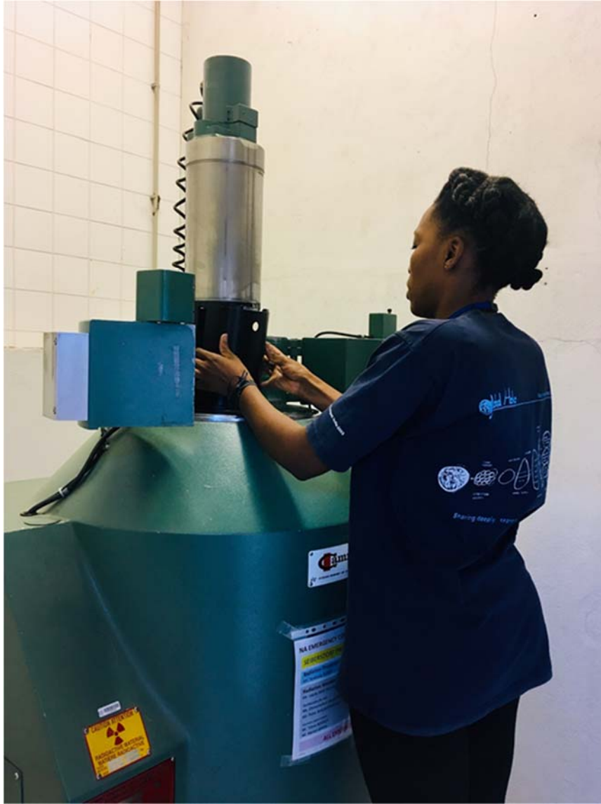
الشكل- باء-١- إدخال ذكور البعوض في غرفة تشعيع جهاز غاماسيل ٢٢٠ بغرض تعقيمها. (المصدر: الوكالة)
