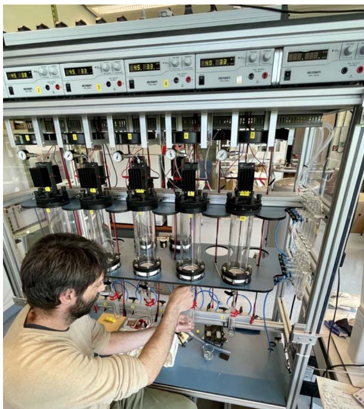
الشكل- باء-١- طريقة جديدة لإثراء التريتيوم تعتمد على تقنية الأغشية النفاذية الإلكترونية. (المصدر: الوكالة)
