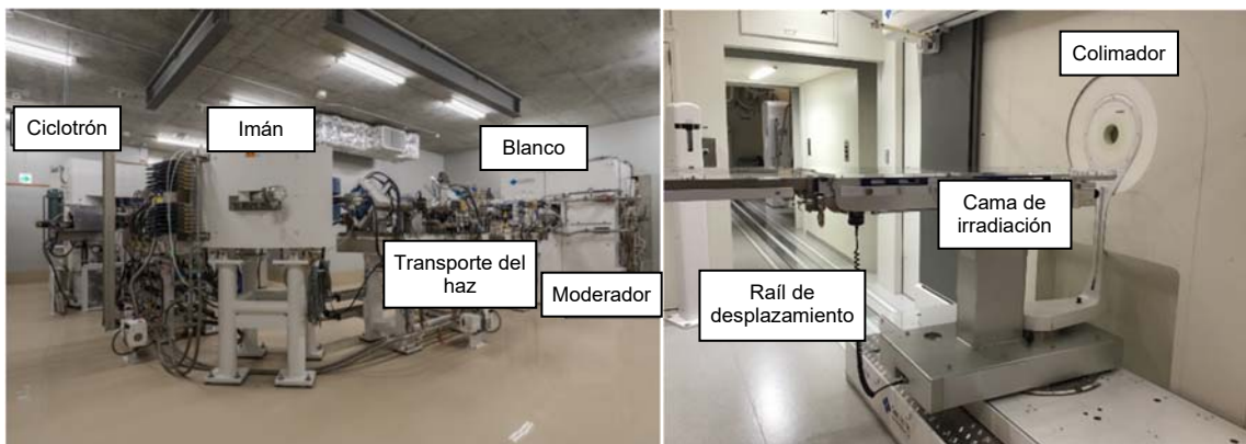
Fig. D-3. Componentes del acelerador y del blanco (izquierda) y sitio de irradiación del paciente (derecha) en un centro de BNCT basada en un acelerador. (Fotografías: Centro Médico de BNCT de Kansai, Japón)
