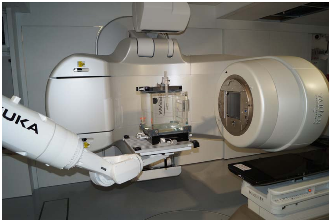
РИС. В.5. Выполнение калибровки при помощи линейного ускорителя с использованием роботизированного стенда в Дозиметрической лаборатории МАГАТЭ в Зайберсдорфе. (Источник: МАГАТЭ)
