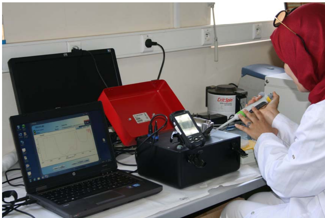
РИС. В.3. Использование инфракрасного Фурье-спектрометра (ИКФС) для измерения состава тела. (Источник: Халид аль-Кари/Марокко)
