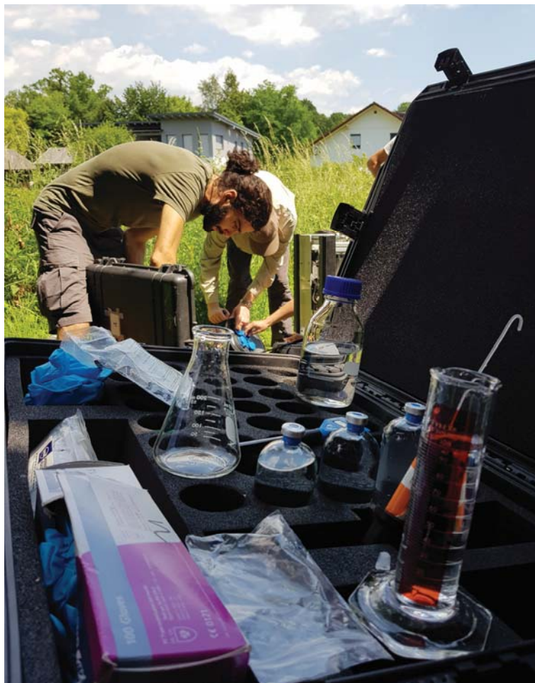
Fig. 1. Muestreo de aguas subterráneas con fines de datación.
