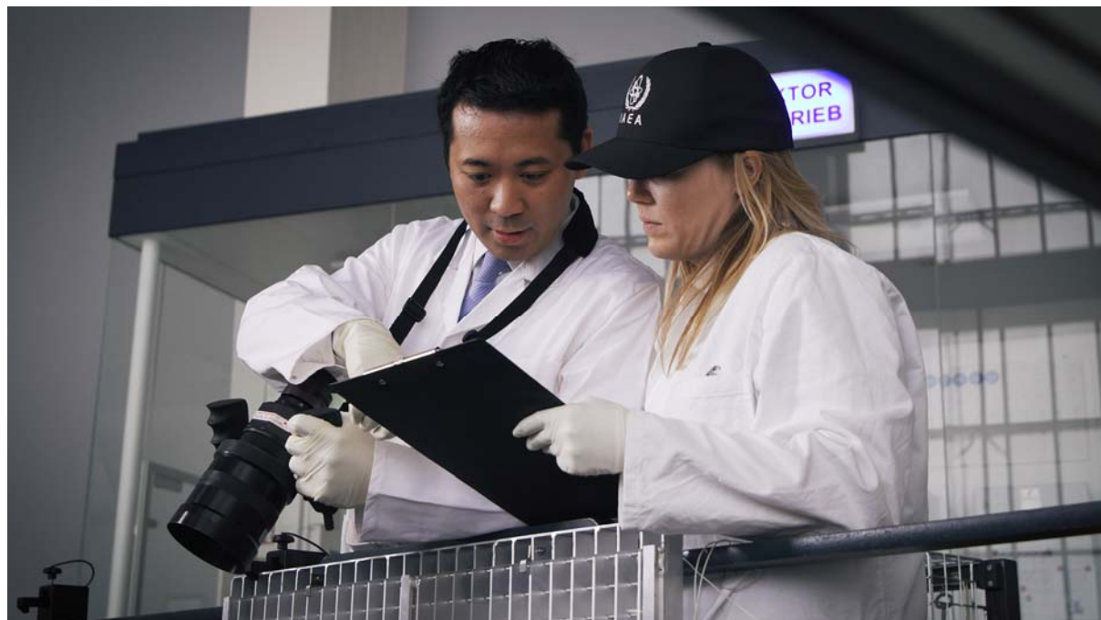
Fig. 3. Inspectores del Organismo verifican la presencia de combustible nuclear gastado en un reactor de investigación utilizando un dispositivo de observación de la radiación de Chérenkov.
