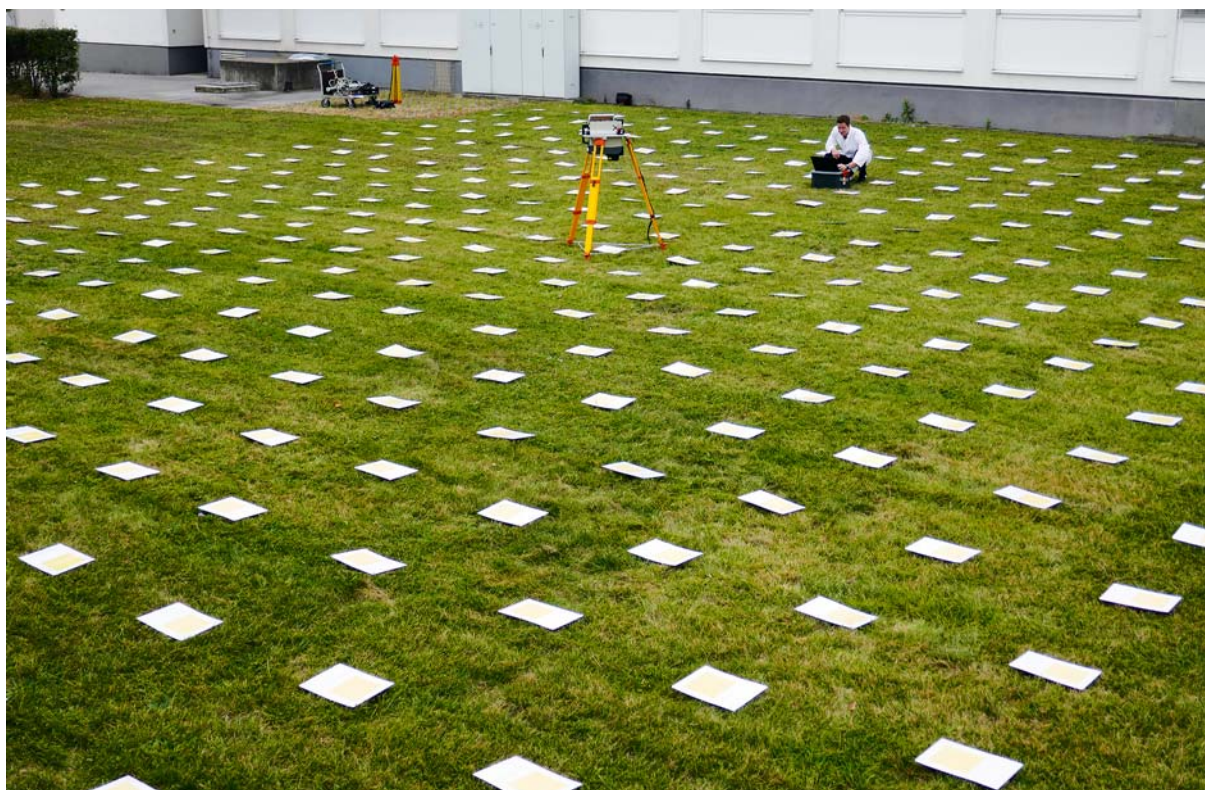
Fig. 1. Calibración sobre el terreno de espectrómetros gamma mediante una nueva técnica de impresión de radionucleidos en hojas de papel; la técnica, desarrollada en el Organismo, también se utiliza ahora para las pruebas de competencia.
