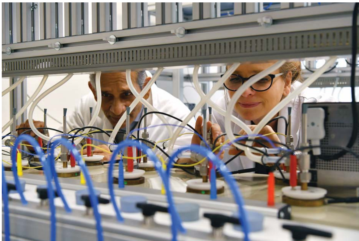
Fig. 2. Preparación de muestras de agua para análisis de tritio que se utilizarán con fines de datación.
