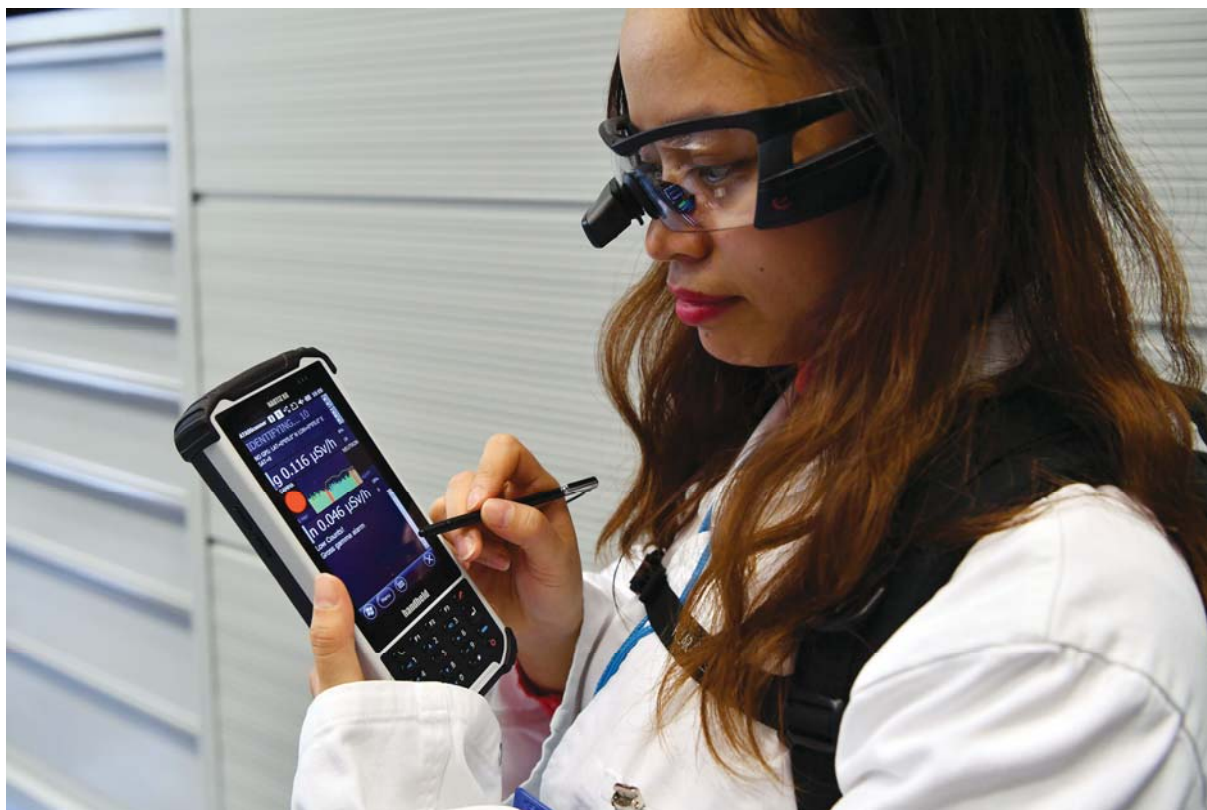
Fig. 4. Una inspectora de salvaguardias del Organismo examina la configuración de una unidad portátil del monitor de radiación portátil, parte del Conjunto de Instrumentos de Varios Componentes para Inspectores (MCIK) Ampliado. El despliegue del MCIK figuraba entre las medidas descritas en la publicación Development and Implementation Support Programme for Nuclear Verification 2020 2021 (STR-393).
