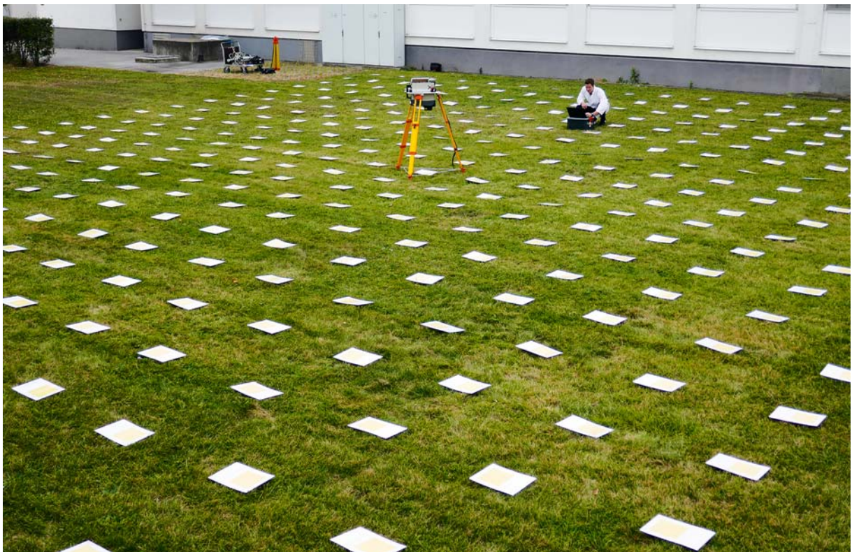
FIG. 1. Étalonnage de spectromètres gamma sur le terrain à l'aide d'une technique innovante mise au point à l'Agence, l'impression des radionucléides sur des feuilles de papier pour les tests de compétence.
