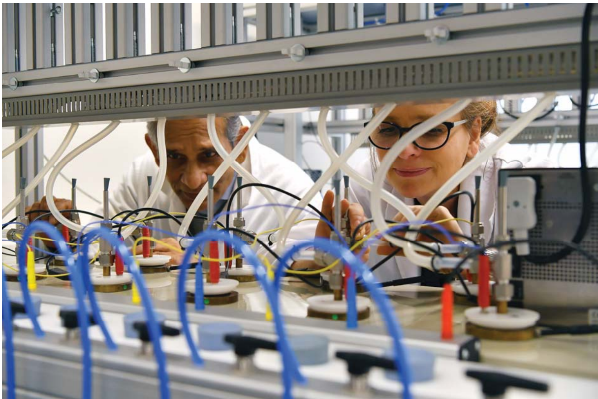
FIG. 2. Préparation d'échantillons d'eau pour l'analyse du tritium aux fins de la datation des eaux souterraines.
