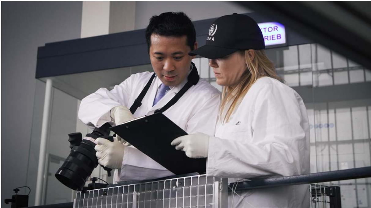
FIG. 3. À l'aide d'un dispositif d'observation de l'effet Tcherenkov, des inspecteurs de l'Agence vérifient la présence de combustible nucléaire usé dans un réacteur de recherche.
