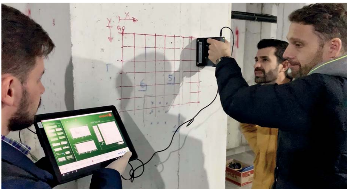
图 1. 在阿尔巴尼亚用非破坏性检测设备进行结构检查。
