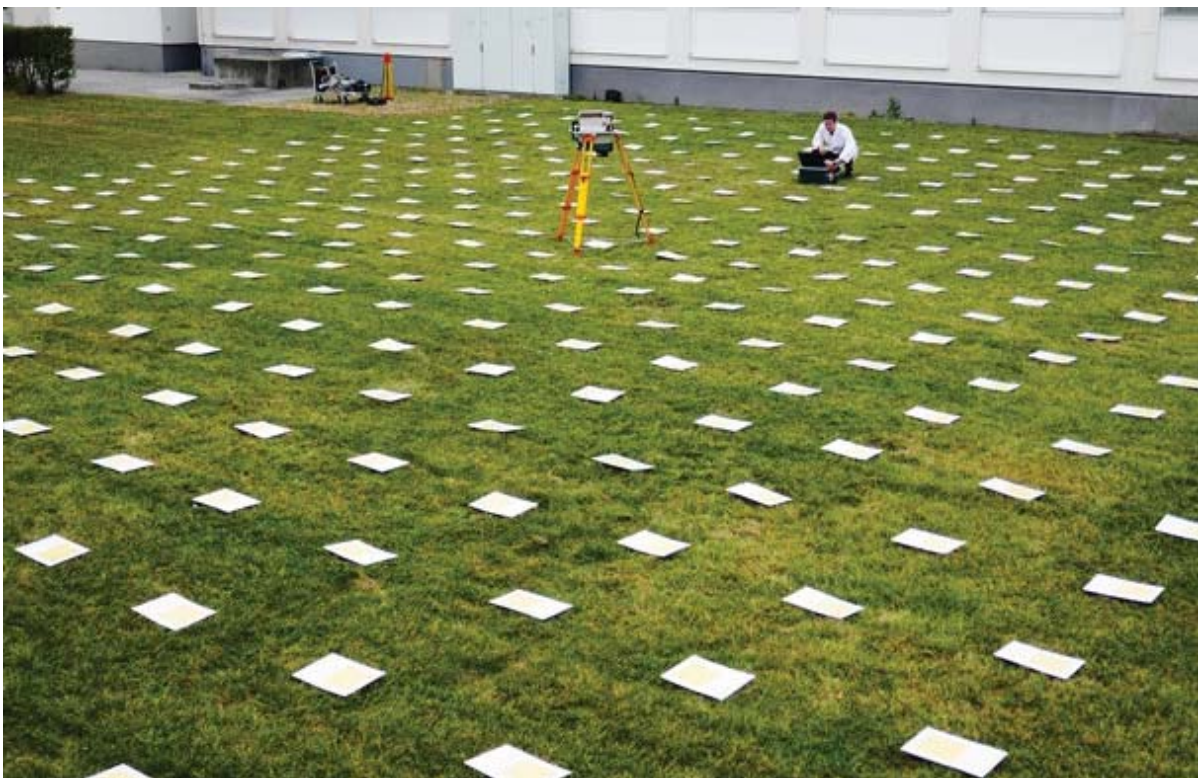
图 1. 用放射性核素压印纸的新技术对 \gamma 光谱仪进行现场校准，原子能机构开发的这项技术现也用于水平测试。
