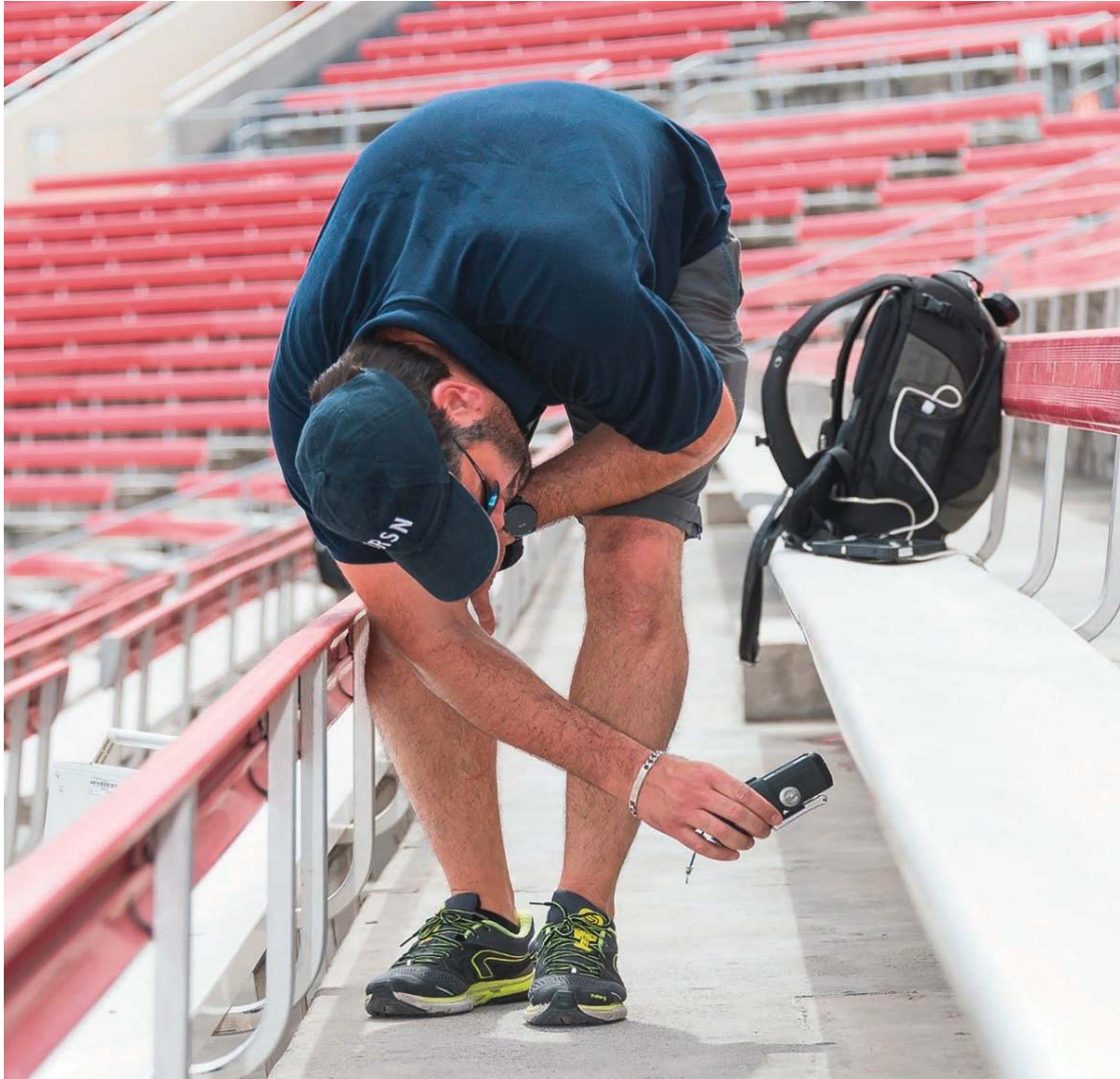
图 1. 在一场模拟的重大体育赛事之前，响应援助网联合援助队的一名成员在“排查”（美利坚合众国）拉斯维加斯的一个体育场，以探测任何隐藏的放射源。 (照片由 S. Carragher 提供)
