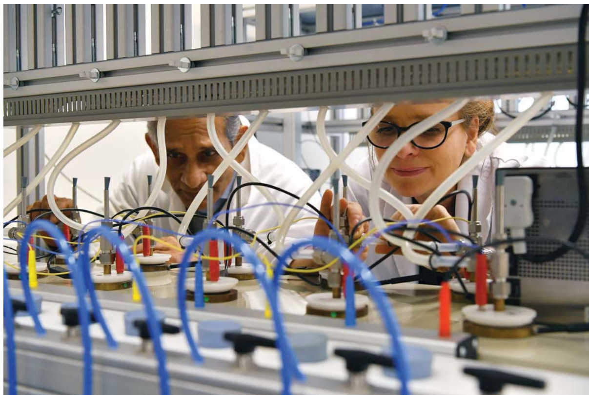
图 2. 准备氙分析水样品，用于地下水测龄目的。
