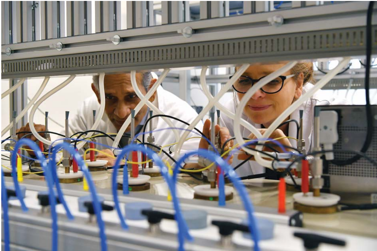
الشكل ٢ - إعداد عينات من المياه لإجراء تحليلات التريتيوم من أجل استخدامها لأغراض تحديد عمر المياه الجوفية.
