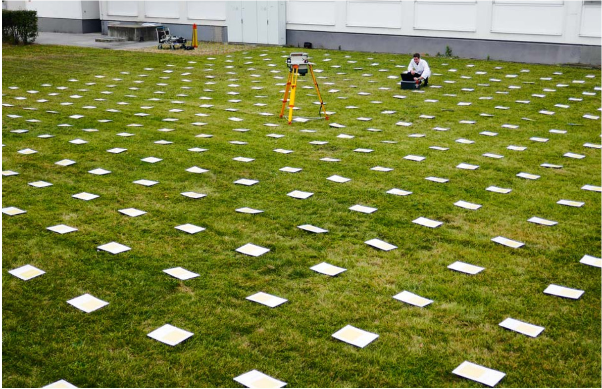
الشكل ١ - معايرة ميدانية لأجهزة قياس طيف أشعة غاما باستخدام تقنية مبتكرة لدمج الأوراق بالنويدات المشعة؛ وهذه التقنية، التي استُحدثت في الوكالة، تُستخدم اليوم أيضاً لاختبار الكفاءة.
