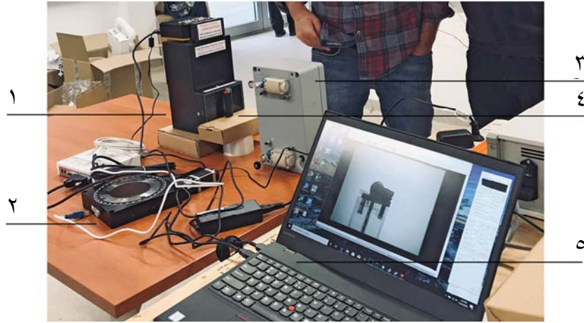
الشكل ٢- اختبار نظام التصوير المزدوج بالأشعة النيوترونية/السينية: (١) صندوق الكاميرا؛ (٢) مرحلة الدوران (غير مستخدمة في هذه الصورة)؛ (٣) مصدر الأشعة السينية؛ (٤) العينة؛ (٥) التحكم الحاسوبي.
