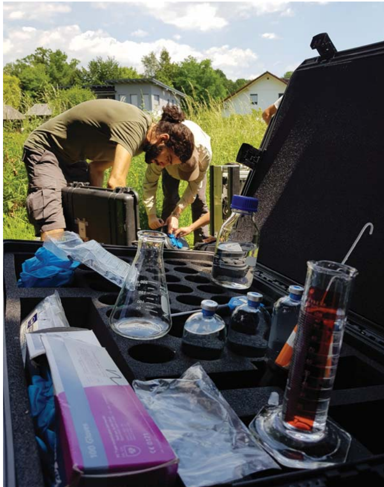
الشكل-١- أخذ عينات المياه الجوفية لأغراض تحديد عمر الكربون ١٤.
