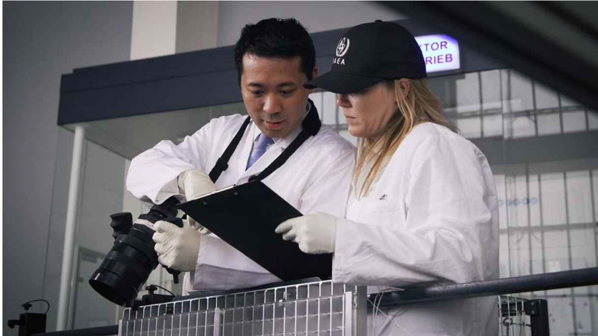
الشكل ٣- مفتشو الوكالة يتحققون من وجود وقود نووي مستهلك في مفاعل بحوث باستخدام جهاز رؤية ظاهرة تشيرينكوف.
