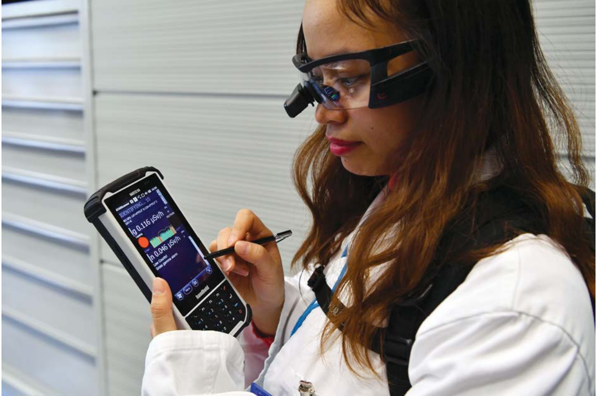
الشكل ٤- مقيّسة ضمانات تابعة للوكالة تستعرض إعدادات على وحدة يدوية متصلة بجهاز الرصد المحمول كحقيبة ظهر، وهو جزء من طقم المفتشين الموسّع المتعدد المكونات. وكان نشر هذا الطقم جزءاً من برنامج دعم التطوير والتنفيذ في مجال التحقّق النووي للفترة ٢٠٢٠-٢٠٢١ (العدد STR-393).
