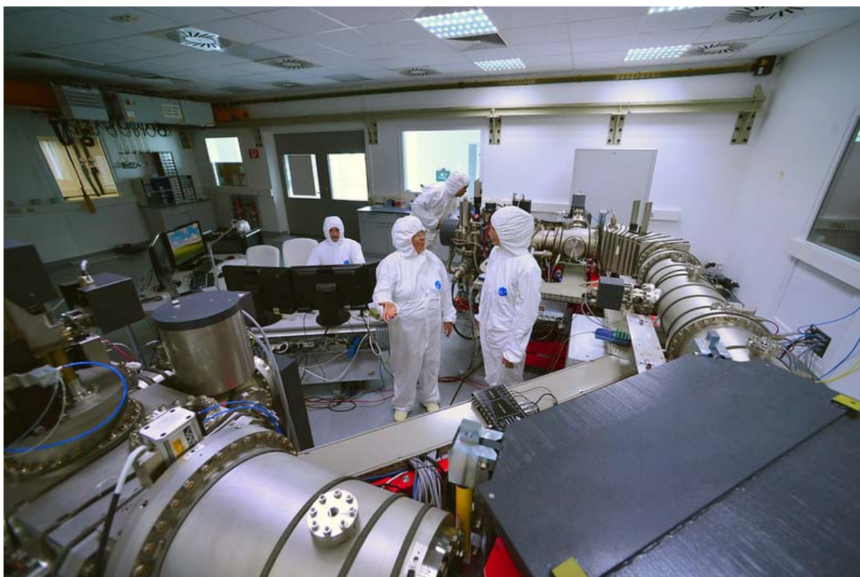
Spectromètre de masse à émission d'ions secondaires (SIMS) au Laboratoire des échantillons de l'environnement, des Laboratoires d'analyse pour les garanties, à Seibersdorf
