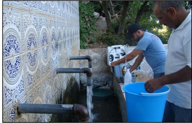
MOR7006：摩洛哥用于化学分析和同位素分析的水采样 — 国家核能、科学和技术中心科学工作者在西部地区平原一眼泉水处采样。照片来源：Acil Ghassan/国家核能、科学和技术中心
