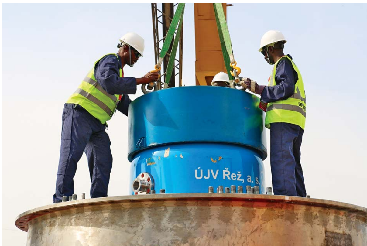
图 2. 工人将高浓铀燃料装入容器，准备于 12 月从尼日利亚运往中国。
