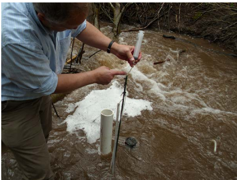
Fig. 1. Toma de muestras de una descarga de aguas subterráneas en un río a través de la subsuperficie.
