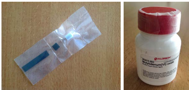
Fig. 1. Muestras de molibdeno natural en forma metálica (izquierda) y de óxido (derecha) utilizadas en el experimento de comparación entre laboratorios con molibdeno 99.
