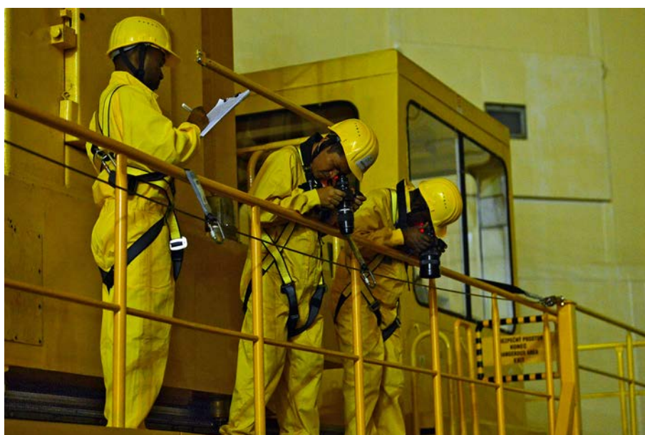
Fig. 3. Inspectores del Organismo utilizando dispositivos de análisis no destructivos para verificar conjuntos combustibles gastados durante un ejercicio de capacitación en la central nuclear de Dukovany (República Checa) en junio.
