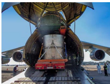
Fig. 2. Un camión cargado con un contenedor de transporte con combustible de UME líquido irradiado entra en un avión que repatriará el combustible a la Federación de Rusia.
