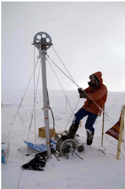
Рис. 2. Отбор ледяного керна (до глубины 181,8 м) на леднике горы Эльбрус, Российская Федерация, для изучения палеоклимата при помощи данных изотопного состава.
