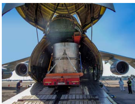
FIG. 2. Chargement dans un avion-cargo d'un conteneur de transport rempli de combustible liquide à l'UHE irradié en vue de la réexpédition de celui-ci en Fédération de Russie.
