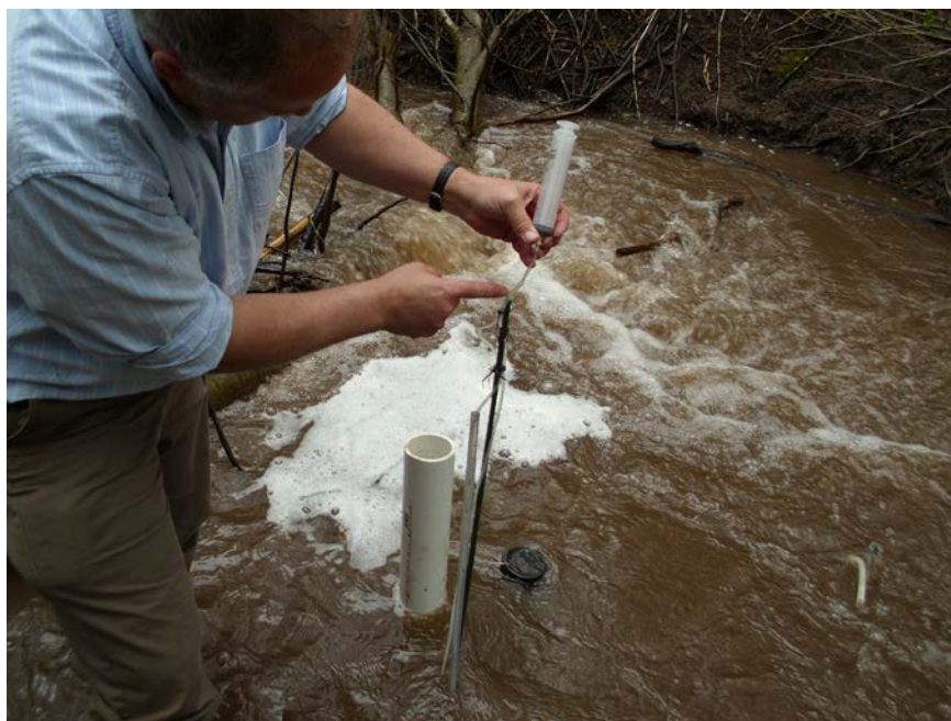
FIG. 1. Prélèvement d'un échantillon d'eaux souterraines s'écoulant à la surface de cours d'eau.
