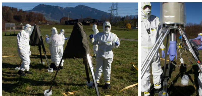
FIG. 1. Exercice de spectrométrie gamma in situ organisé en Suisse dans des conditions d'urgence simulées.
