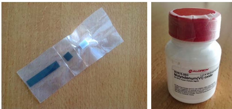
FIG. 1. Échantillon de molybdène naturel métallique (à gauche) et échantillon d'oxyde de molybdène naturel (à droite) utilisés dans l'exercice interlaboratoires sur le molybdène 99.
