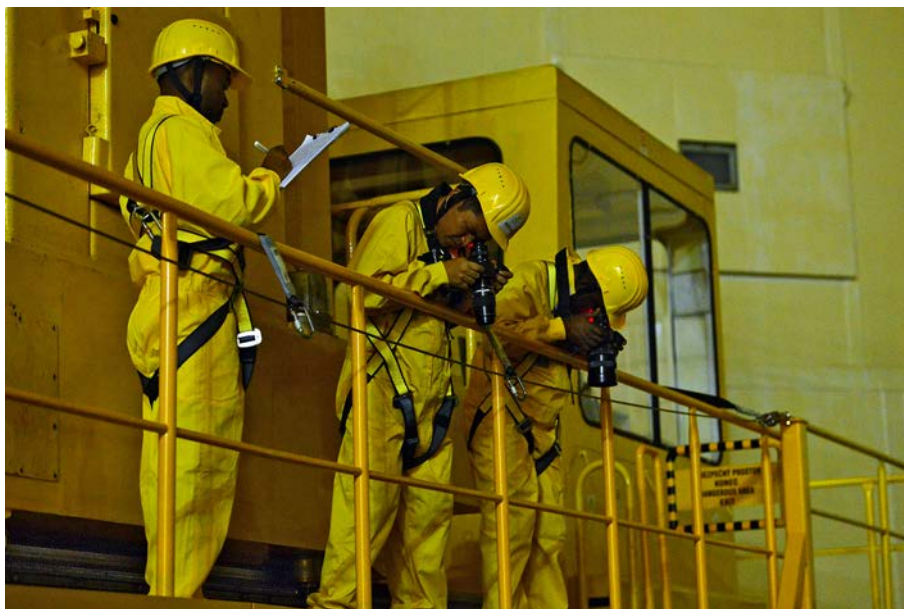
FIG. 3. Des inspecteurs de l'Agence utilisent des dispositifs d'analyse non destructive pour vérifier des assemblages de combustible usé lors d'un exercice d'entraînement à la centrale nucléaire de Dukovany (République tchèque), en juin.
