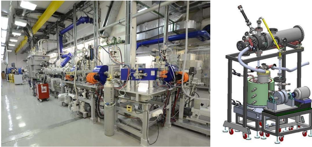
Fig. D-4. Acelerador lineal de protones/deuterones superconductor y de alta potencia (200 kW) (izquierda), combinado con tecnología innovadora de blancos de litio líquido para la producción de neutrones (derecha). (Imagen: Dan Berkowitz, Centro de Investigaciones Nucleares de Soreq, Israel)
