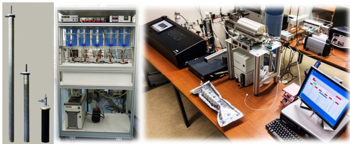
Fig. 2. En 2013 concluyó el desarrollo y ensayo de un sistema de enriquecimiento electrolítico de tritio de alto rendimiento para la datación de aguas subterráneas (izquierda, centro). Prueba de un espectrógrafo de absorción con láser en el Laboratorio de Hidrología Isotópica del OIEA para analizar el contenido de carbono 13 en el carbono disuelto en muestras de agua (derecha).
