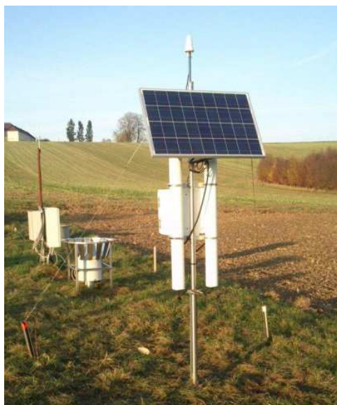
Fig. 2. Sistema de observación de la humedad del suelo mediante rayos cósmicos en Petzenkirchen (Austria).
