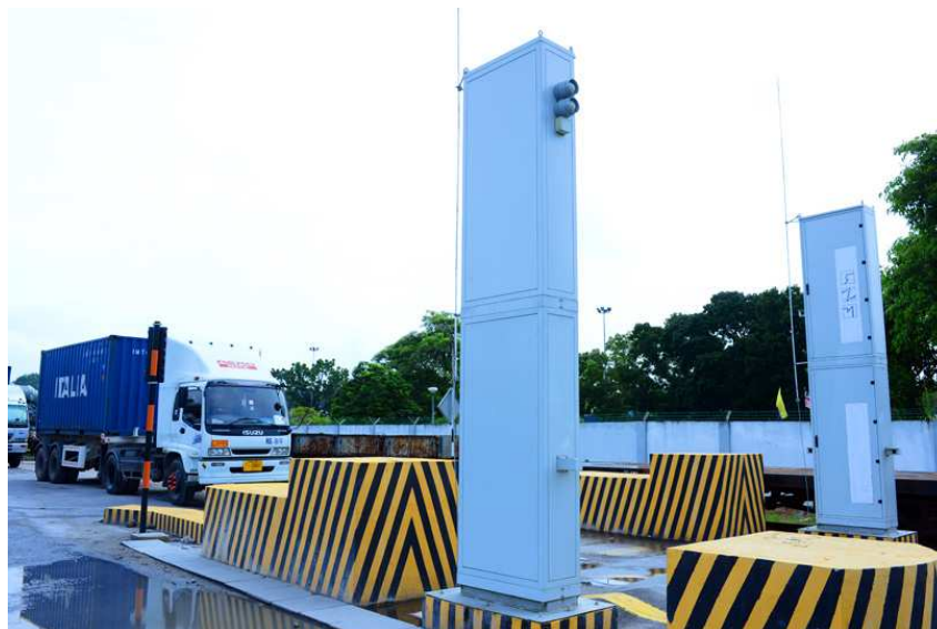
Fig. 1. Monitor de radiación de pórtico en la frontera entre Tailandia y Malasia. Este dispositivo detecta la radiación en tiempo real sin interrumpir las operaciones normales de importación y exportación.
