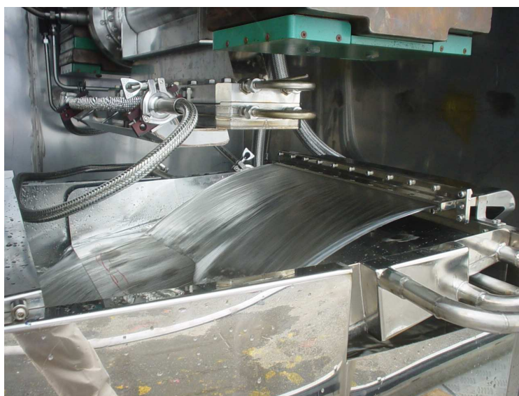
Fig. 2. Tratamiento de aguas residuales industriales mediante haces de electrones para lograr una mayor inocuidad antes de su vertimiento. (Fotografía por cortesía de EBTech.).
