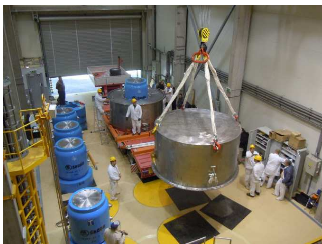
Fig. 2. Descarga de contenedores de doble uso (azules) adquiridos por el Organismo en bultos de transporte TUK-145/C utilizados para la repatriación del combustible gastado de UME en el emplazamiento del reactor de investigación del Instituto de Investigaciones sobre Energía Atómica del KFKI en Budapest.
