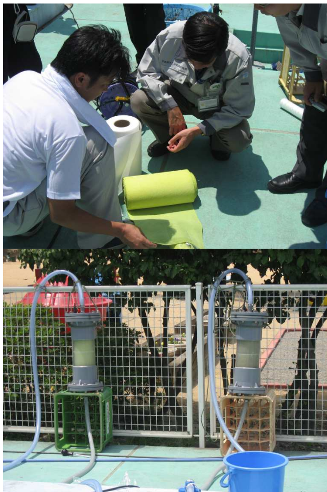
Рис. Н.1. Использование радиационно-привитых мембран для удаления радиоактивного цезия из воды в районе АЭС «Фукусима» (публикуется с разрешения ЯААЭ, Такасаки, Япония).
