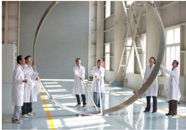
图 B-2. 正在起吊国际热核实验堆使用的超导校正场线圈，中国合肥等离子体物理研究所。
