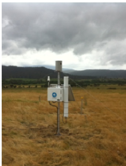
图 D.1. 安装在澳大利亚一座牧场的“宇宙射线土壤水分观测系统”（照片由英联邦科学和工业研究组织克里斯·史密斯博士提供：土地和水，堪培拉）。
