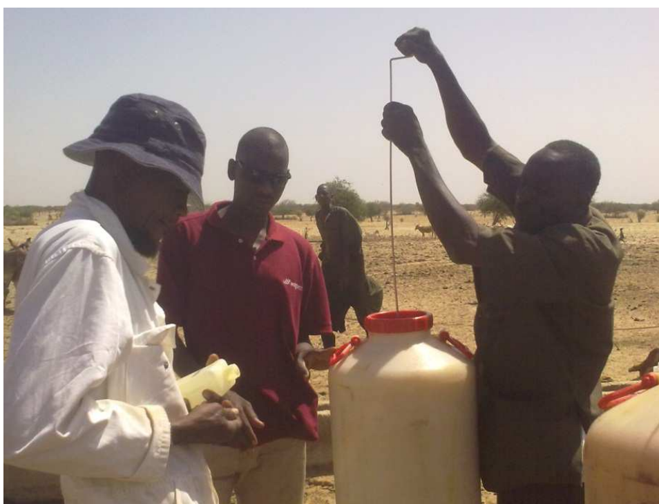
图1. 在尼日尔开展利用碳-14测定地下水年龄的取样活动。
