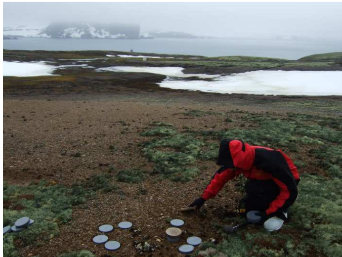
图 7. 在南极（阿德利岛）进行土壤取样供用于散落放射性核素分析将有助于评定气候变化对土壤重新分布的影响。
