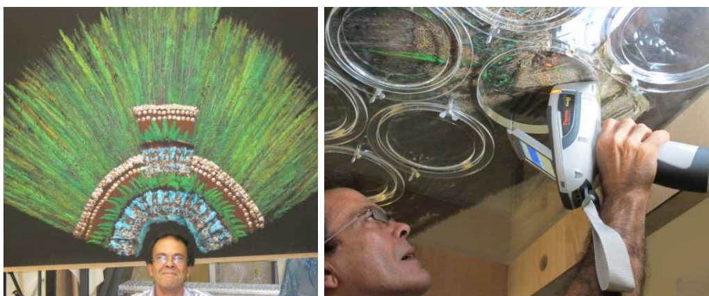
图 5. 16 世纪墨西哥人的头饰（左图）正在被用手持 X 射线荧光光谱测定仪（右图）进行检验。
