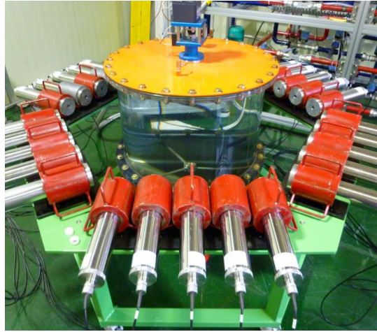
图 3. 用于发生器中镓-68 和钷-137m 放射性示踪剂可视化的工业单光子发射计算机断层照相系统。
