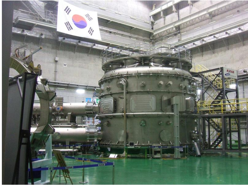
图 B-1. 大韩民国大田韩国国家聚变研究所的韩国超导托卡马克先进研究装置。
