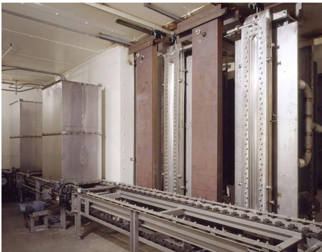
Fig. I-2. Tratamiento de contenedores de materiales (por ejemplo, productos médicos desechables, productos alimenticios) con rayos X generados por haces de electrones de 5 a 7.5 MeV.
