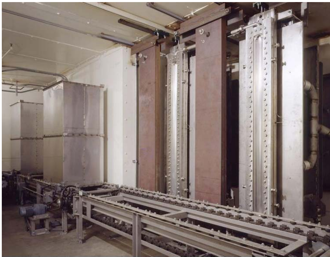
Рис. 1-2. Контейнеры с материалами (например, одноразовыми медицинскими изделиями, пищевыми продуктами) перемещаются для обработки рентгеновскими лучами из электронных пучков с силой тока 5–7,5 МэВ.
