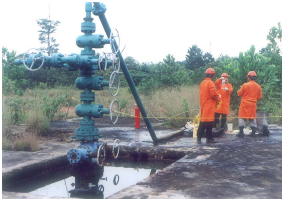
Fig. 1: Inyección de agua tritiada (THO) como trazador para el estudio entre pozos en un yacimiento petrolífero en Indonesia.
