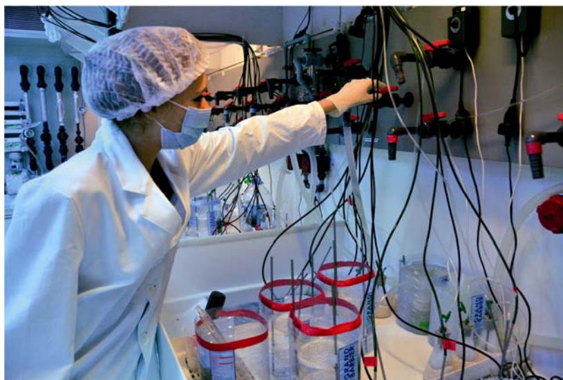
Fig. 1. Sistema experimental utilizado en los OIEA-MEL para evaluar los efectos de la exposición de peces y mariscos con valor comercial a agua de mar con los niveles de pH más bajos que predicen los modelos del cambio climático.
