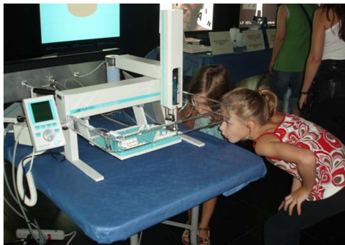
Fig. 2. Se espera que la disponibilidad de datos isotópicos mejore el uso ordinario de los analizadores isotópicos basados en rayos láser, que son más económicos y fáciles de utilizar que los espectrómetros de masas tradicionales.
