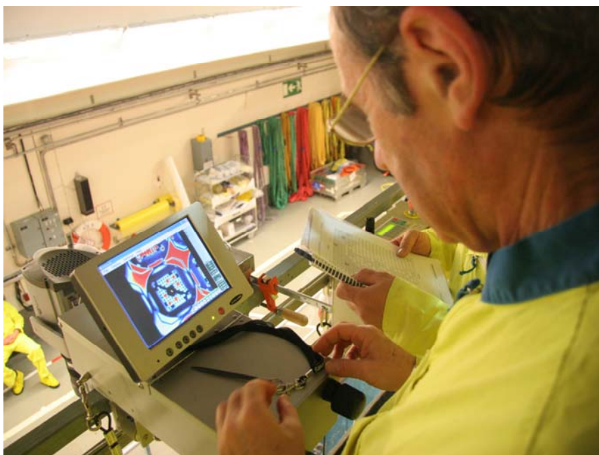
Fig. 2. Verificación de combustible gastado con el empleo de un dispositivo digital de observación del brillo de Cherenkov.
