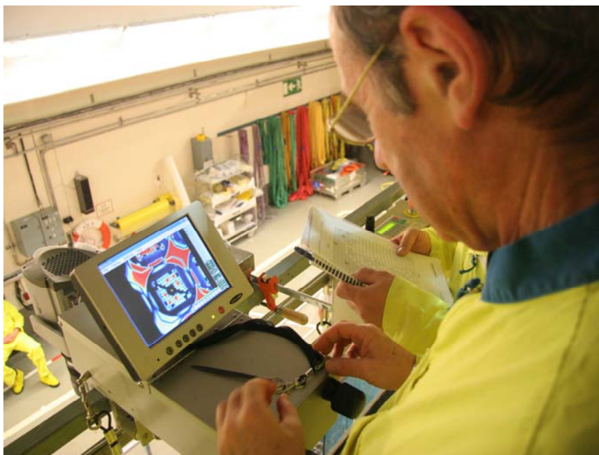
FIG. 2 Vérification de combustible usé avec un dispositif numérique d'observation de l'effet Tcherenkov.
