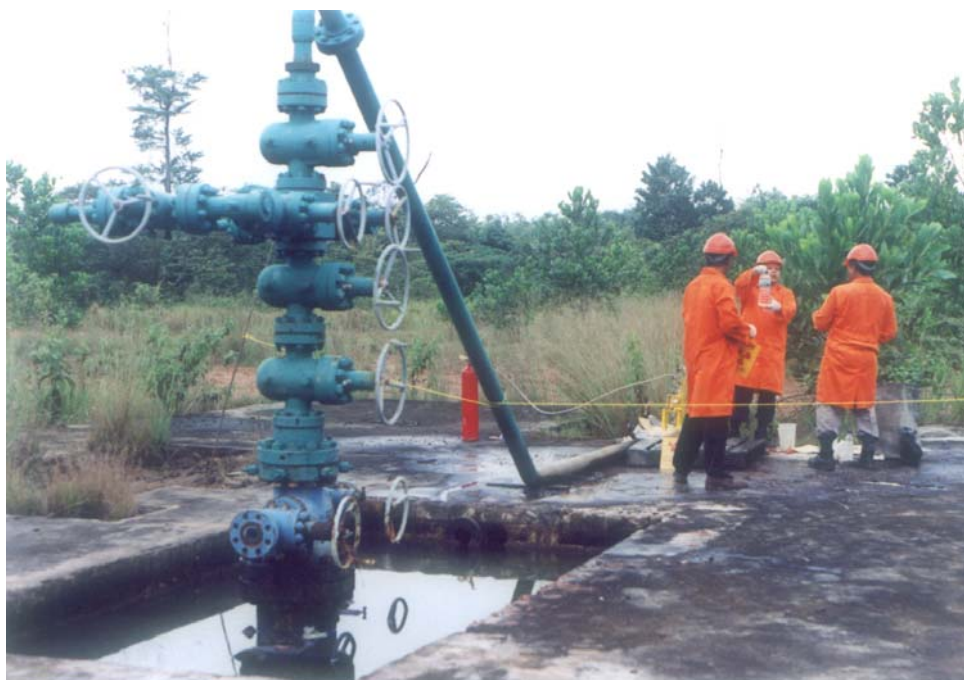
FIG. 1. Injection d'eau tritiée comme traceur pour les études inter-puits sur un champ pétrolière en Indonésie.
