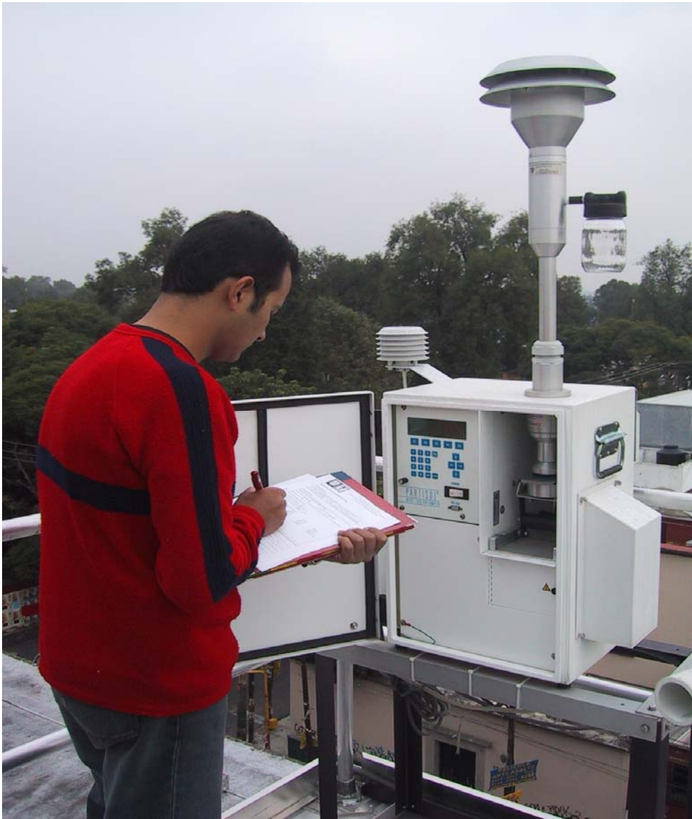
图11. 一名技术人员正在墨西哥城大都市地区科约阿坎区大气取样站从微粒气样中收集当前的运行数据。（照片由墨西哥国家核研究所提供）
