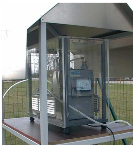
FIG. H-3 : Échantillonneur d'air de grand volume utilisé pour le suivi de la pollution atmosphérique ou du radon.
