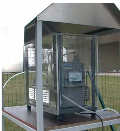
图 H-3. 用于进行大气污染或氡监测的大容积空气取样器。
