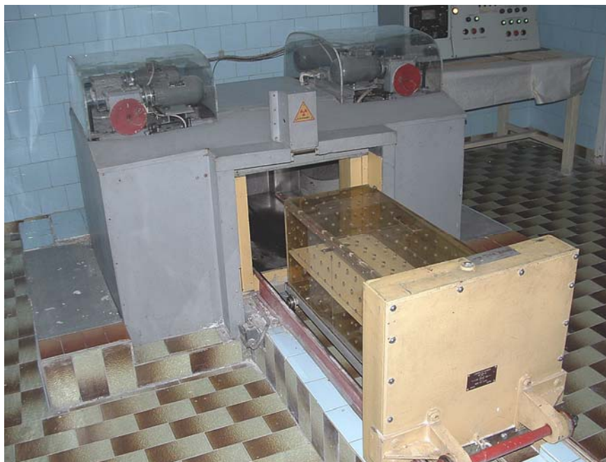
FIG. 1. Un antiguo irradiador con fuentes de cesio 137 en Bulgaria antes de su clausura.
