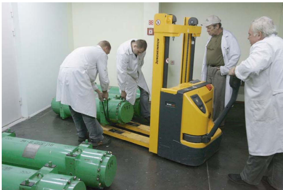
FIG. 1. Manipulación de un cofre de transporte con UME sin irradiar antes de su devolución a la Federación de Rusia en el marco del programa RRRFR.
