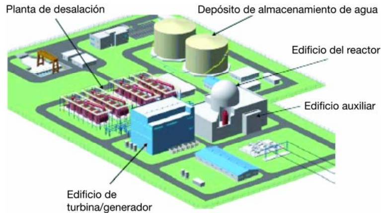
FIG. 2. Ejemplo de un RPMP: el reactor modular avanzado integrado en un sistema (SMART) de la República de Corea (cortesía: KAERI).
