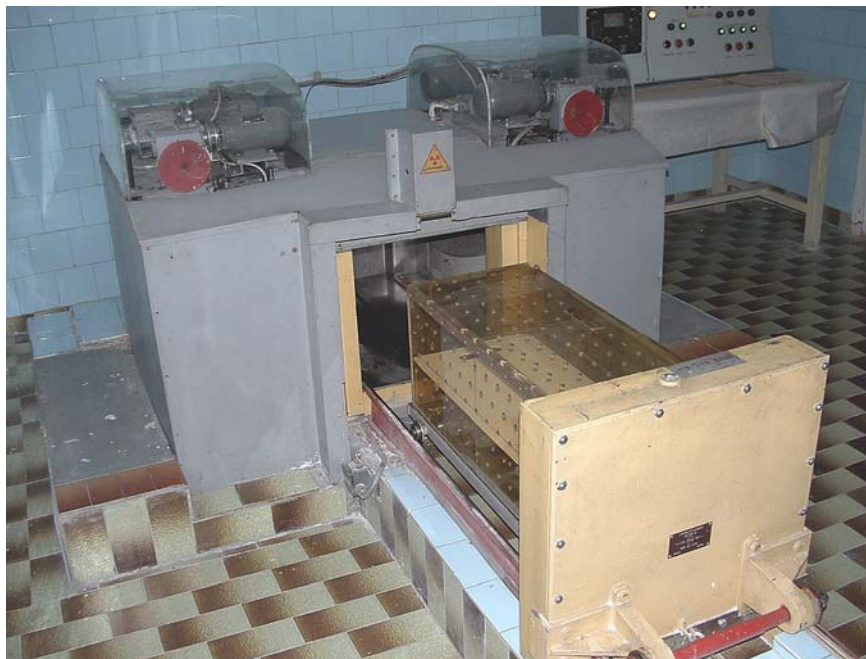
Fig. 1. Irradiateur renfermant des sources de césium 137 en Bulgarie avant les opérations de déclassement.
