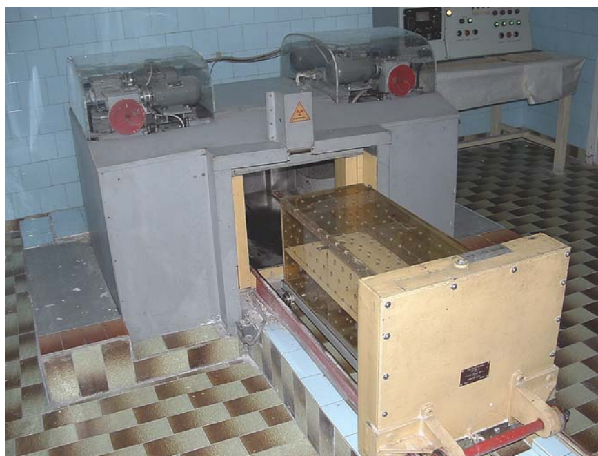
图1. 保加利亚准备退役的一个含铯-137的旧辐照器。
