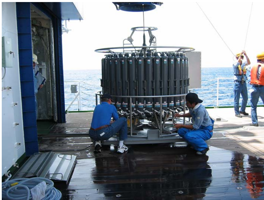
图 2. 采集海水和粒子样品以测量天然放射性示踪剂。
