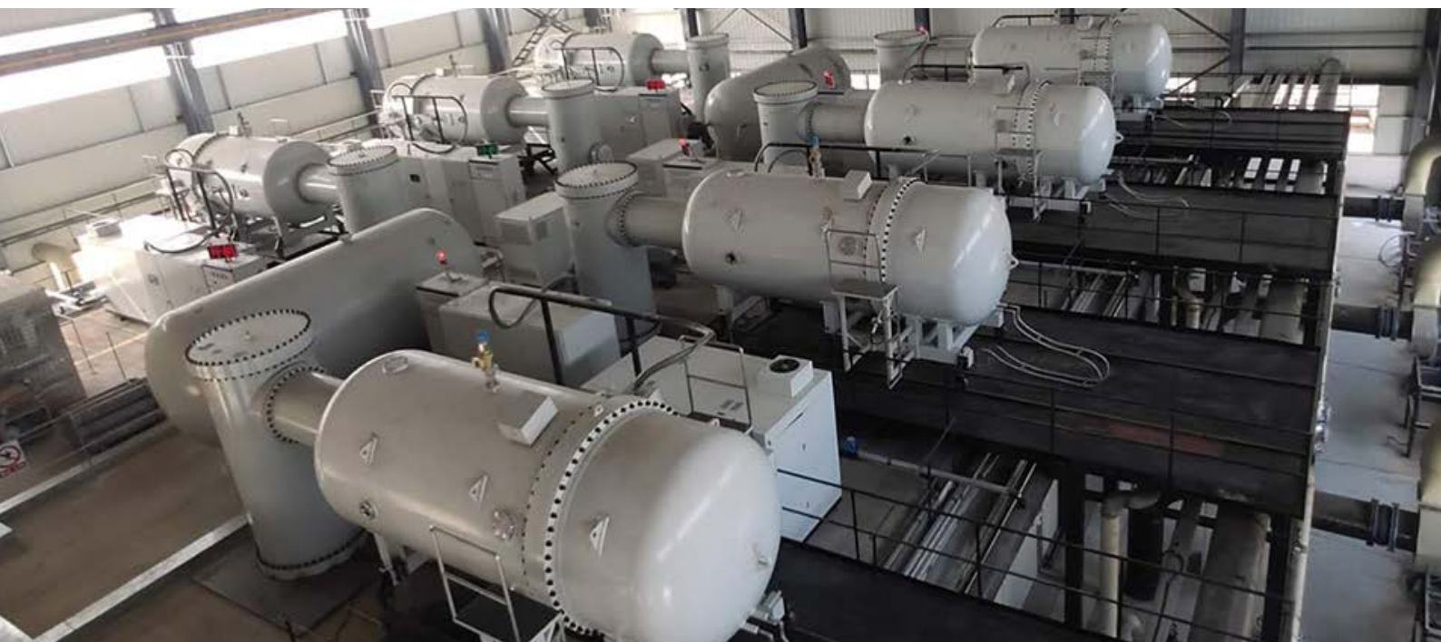
Siete aceleradores de electrones mediante los cuales se tratan aguas residuales de los procesos de impresión y teñido en Guanhua Knitting Factory. (Fotografía: Instituto de Tecnología de la Energía Nuclear y de las Nuevas Energías, Universidad de Tsinghua)
