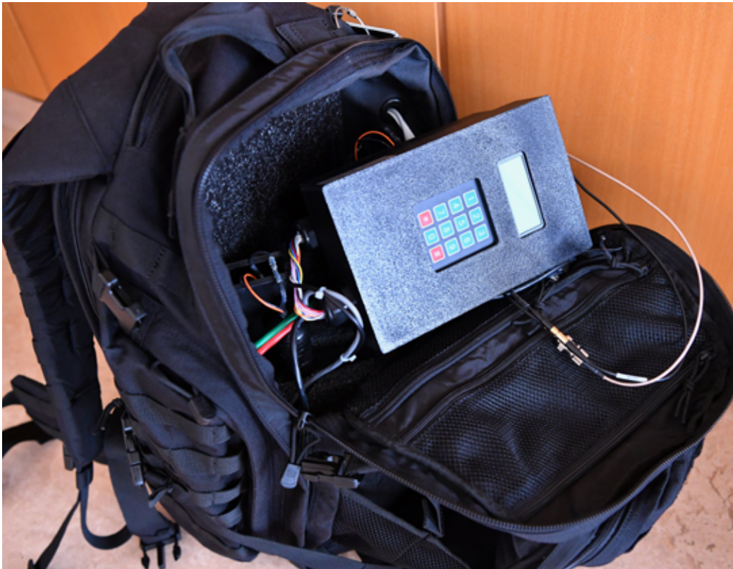
辐射探测背包里面东西。 （图/国际原子能机构D. Calma）
