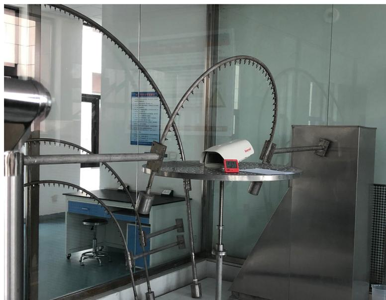
**Использование имитатора дождя для проверки надежности камеры видеонаблюдения.**
