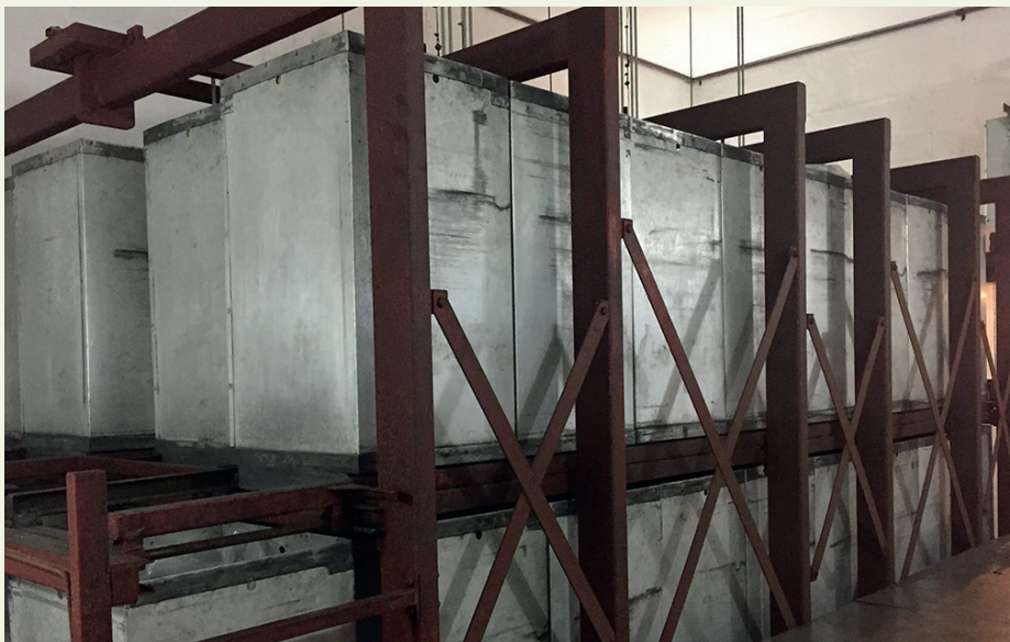
Высокие алюминиевые ящики, заполненные пищевыми продуктами, ожидают прохождения через гамма-облучатель. (Фото: Э. Маре/МАГАТЭ)
