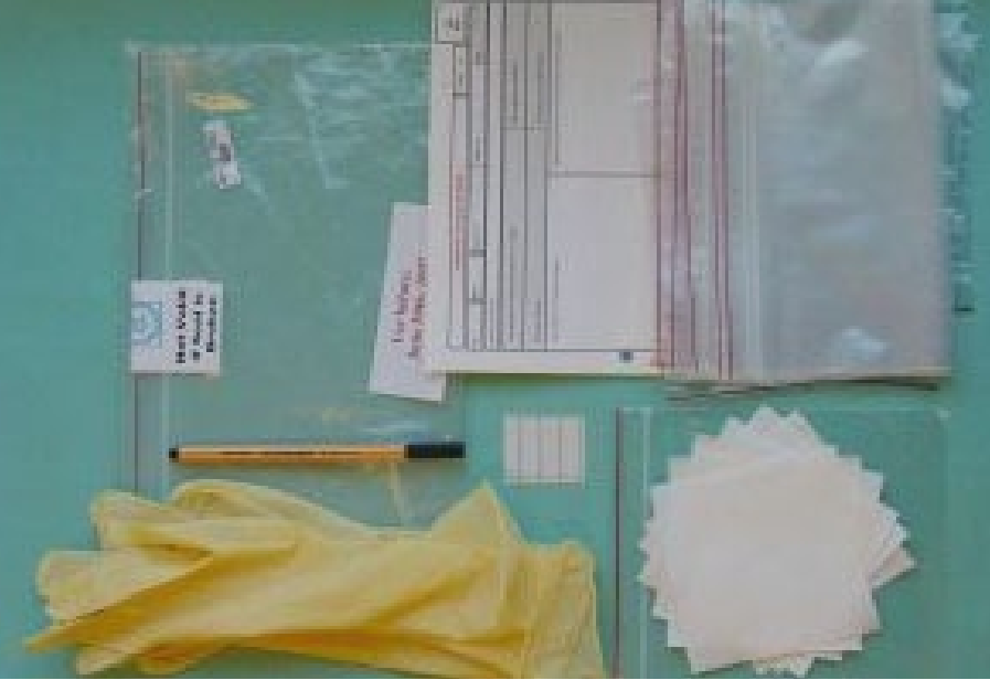
طقم أدوات خاص بالعينات يُستخدم في أخذ العينات البيئية. (الصورة من: إدارة الضمانات التابعة للوكالة)
