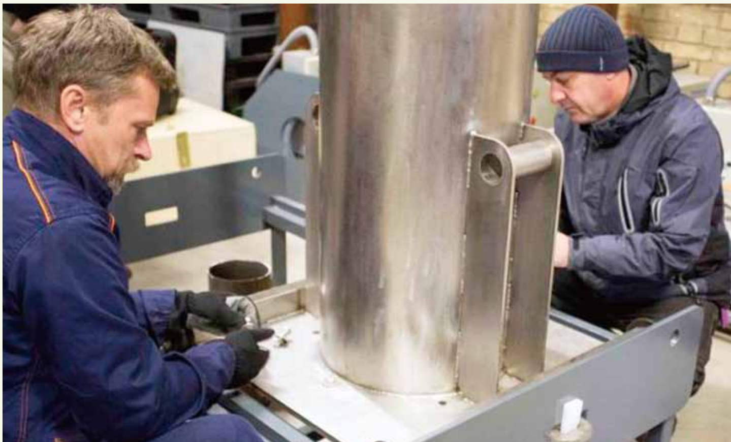
国际原子能机构工程师和克罗地亚辐射防护公司对用于在钻孔中安全和可靠处置低放源的新系统进行试验。
