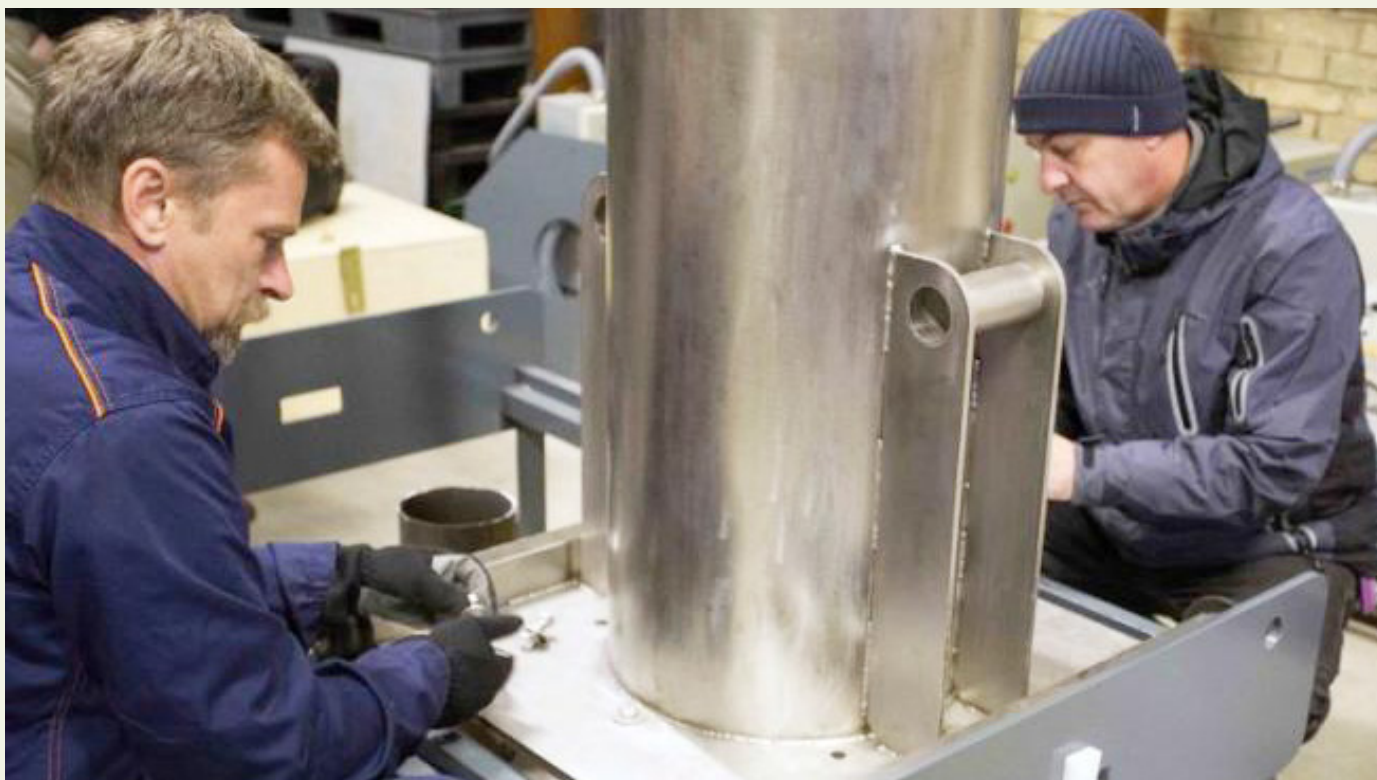
Des ingénieurs de l'AIEA et une société croate de radioprotection mettent à l'essai un nouveau système permettant de stocker définitivement, de manière sûre et sécurisée, des sources de faible radioactivité dans des puits. [Photo: L. Gil (AIEA)]
