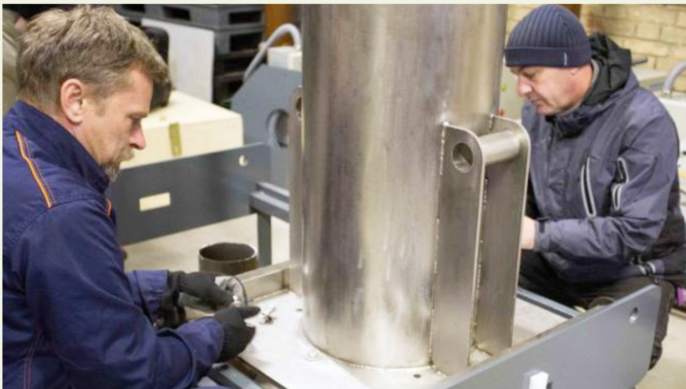
Ingenieros del OIEA y una empresa croata de protección radiológica prueban un nuevo sistema de disposición final segura de fuentes de baja actividad en pozos barrenados. (Fotografía: L. Gil, OIEA)
