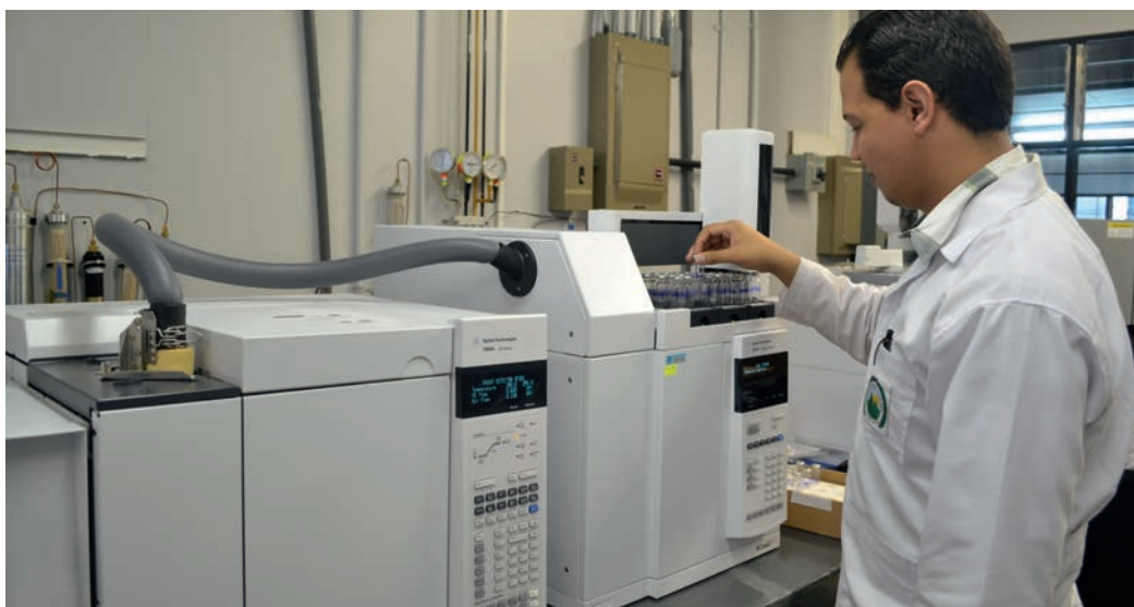
Analyse d'échantillons prélevés en champ à l'aide d'un chromatographe gazeux avec autoéchantillonneur d'espace de tête.
