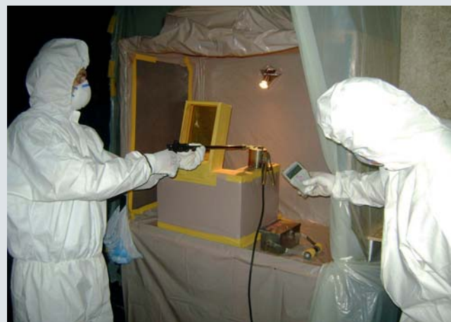
Проверка уровня радиоактивности капсулы, содержащей кондиционированные источники с цезием-137.
