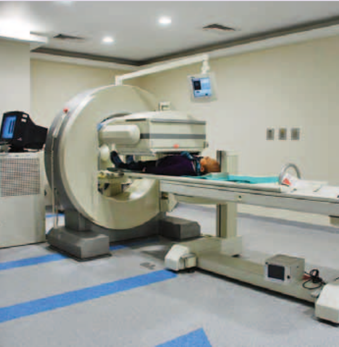
جهاز تصوير بأشعة غاما يقتفي ويكشف المستحضرات الصيدلانية الإشعاعية لإنتاج صور تشخيصية.
