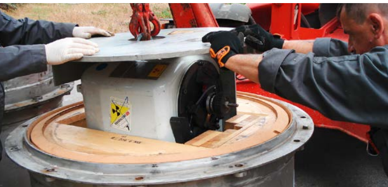
Trabajadores colocando fuentes radiactivas en un contenedor de transporte para su envío a Francia.
